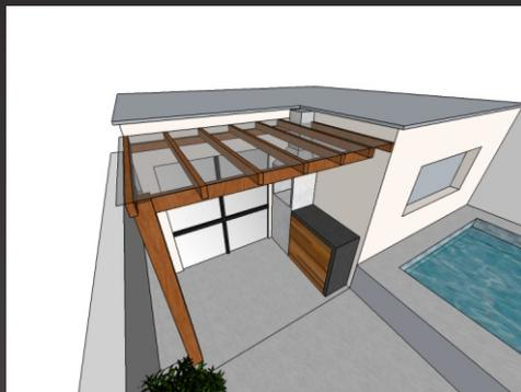
Projeto do Pergolado de Madeira com madeira Imbirá, e Policarbonato Compacto 3mm Fumê. Possui Iluminação LightWood em barra, e calha sob-medida na cor preto fosco.
