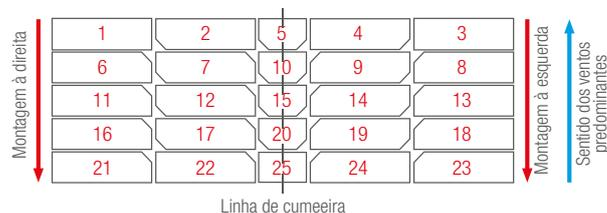
No recobrimento de quatro cantos de telha, os dois intermediários devem ser cortados, conforme a figura abaixo:
